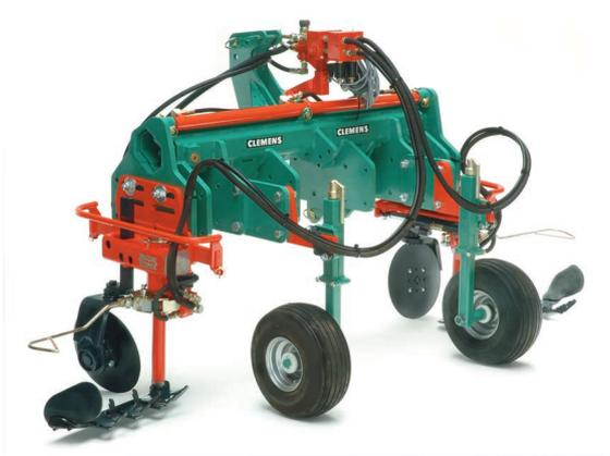
Montage avant ou arrière, ou cadre intermédiaire. Porte-outils pour l'intercep hydraulique RADIUS ou épampreuse.
