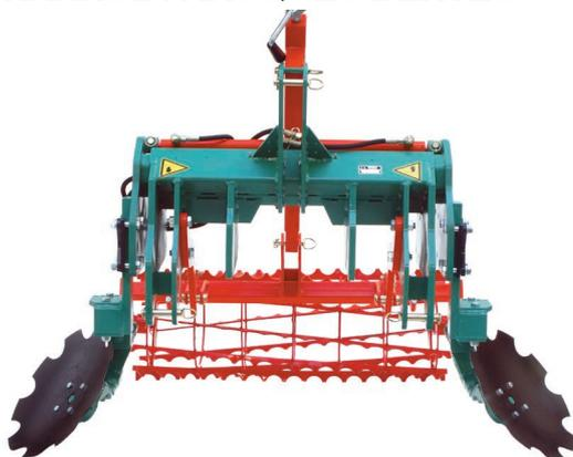
Pour l'aération rationnelle dans la zone sensible entre les ceps et pour une lutte simultanée contre les mauvaises herbes.
